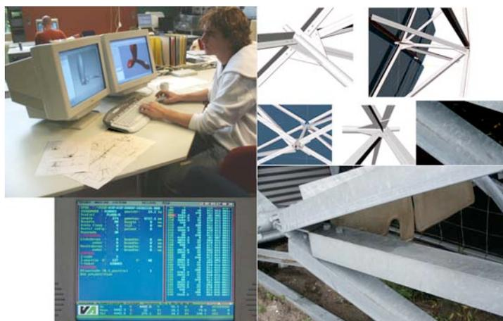
**Image 5 :** « ONL, Rotterdam (Pays-Bas). Kaas Oosterhuis (Architecte) et Ilona Lenhard (Plasticienne). Collaboration avec l'entreprise Meijers Staalbouw BV (charpente métallique) pour développer et mettre en œuvre le process de « file to factory ». Ce process est continu depuis l'élaboration du modèle 3D paramétrique détaillé jusqu'à la fabrication des éléments constitutifs et leur positionnement sur le chantier. »
